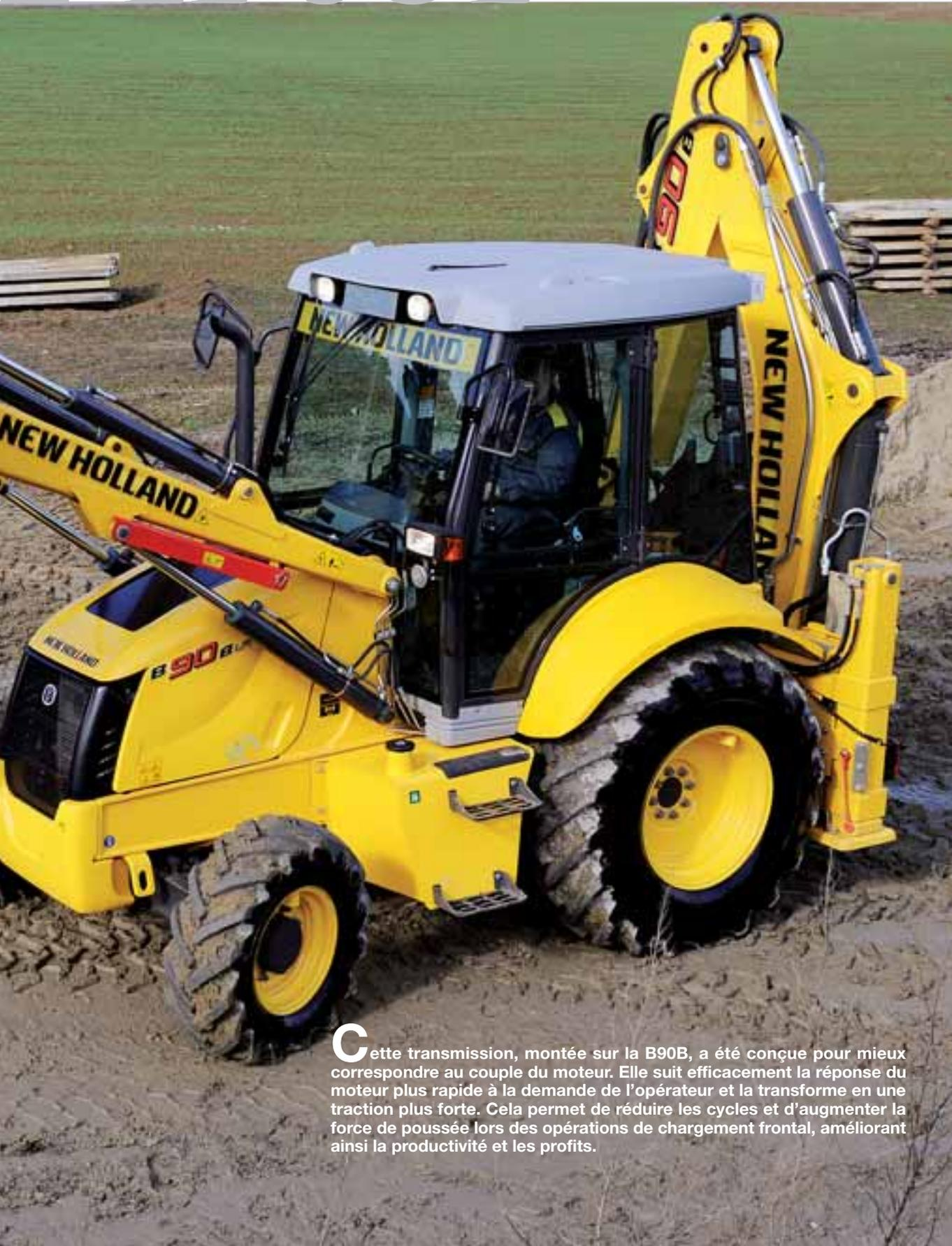
Cette transmission, montée sur la B90B, a été conçue pour mieux correspondre au couple du moteur. Elle suit efficacement la réponse du moteur plus rapide à la demande de l'opérateur et la transforme en une traction plus forte. Cela permet de réduire les cycles et d'augmenter la force de poussée lors des opérations de chargement frontal, améliorant ainsi la productivité et les profits.
